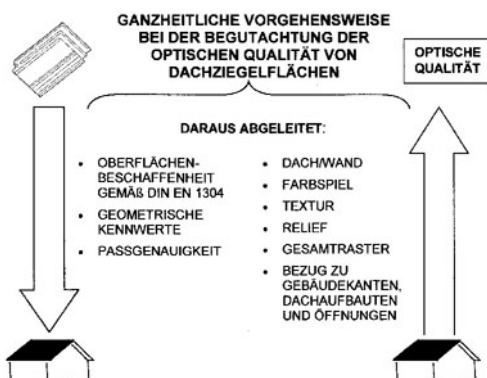
Schema: Gesamtstruktur Dachziegel/Dachfläche
